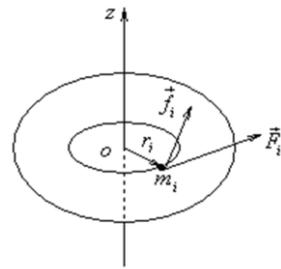
图 3-5 推导刚体定轴转动定律用图
