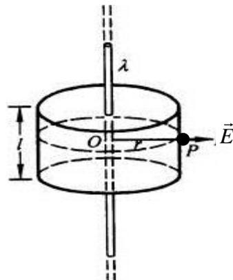
图 9-16 无限长的均匀带电直线的场强
