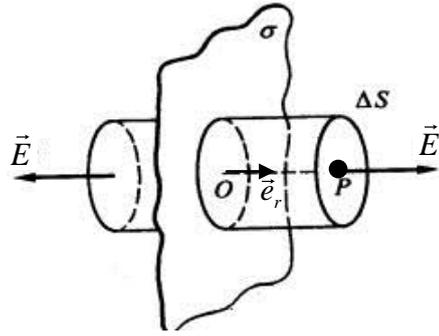
图 9-17 无限大均匀带电平面的电场
