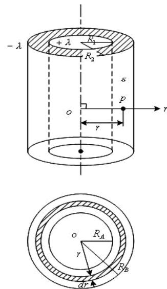
图 9-50 圆柱形电容器贮存能量的计算
