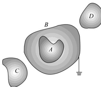
图 9-39 屏蔽的电容器
