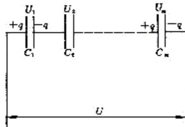
图 9-44 电容器的串联
