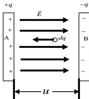
图 9-48 把  $+dq$  电荷从带负电极板移到带正电极板，外力作功  $dW=udq$
