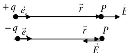
图 9-4 静止点电荷的电场强度
