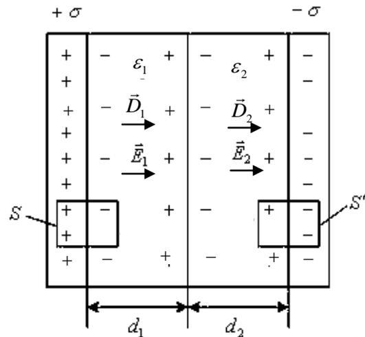
图 9-47 充满两种均匀电介质的平行板电容器
