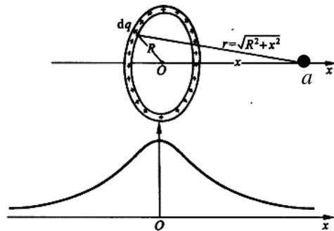
图 9-22 均匀带电圆环轴线上的电势
